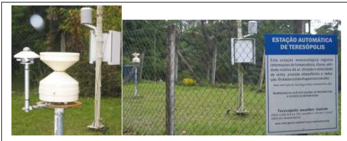
Figura 4.4 - Na fotografia a direita, uma vista parcial do sítio da Estação Meteorológica do INMET, instalada na sede do Parque Nacional da Serra dos Órgãos na Cidade de Teresópolis – RJ. Na fotografia esquerda um detalhe de alguns dos sensores da Estação, como o pluviômetro em 1º plano.
