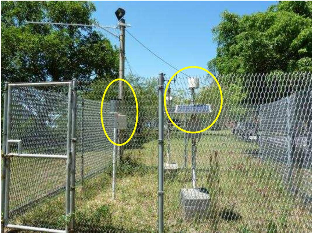
Figura 4.5 – Estação Automática da CRT, BR 116 KM 94,7 (Posto Garrafão). Neste sítio existem duas estações em funcionamento, sendo que uma transmite por GPRS e a outra por fibra ótica.
