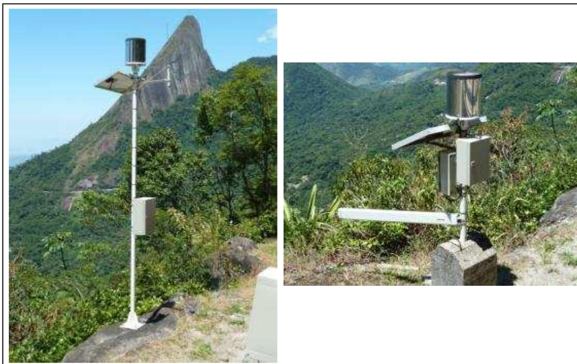
Figura 4.7 – Detalhe das estações da CRT no KM 90 da BR 116. A fotografia da esquerda mostra a estação que envia os dados por satélite (Orbconn); a fotografia da direita mostra a estação que transmite seus registros por cabo de fibra ótica.
